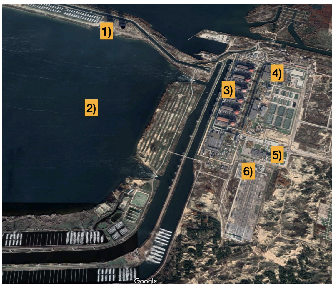
Figura 3: Veduta dall'alto della centrale. 1) Torri di raffreddamento 2) Bacino di Raffreddamento 3) Reattori 4) Sito stoccaggio combustibile esausto (SFDSF) 5) Uffici teatro degli scontri del 4 Marzo 6) Piloni Elettrici. Credits: Google maps.
