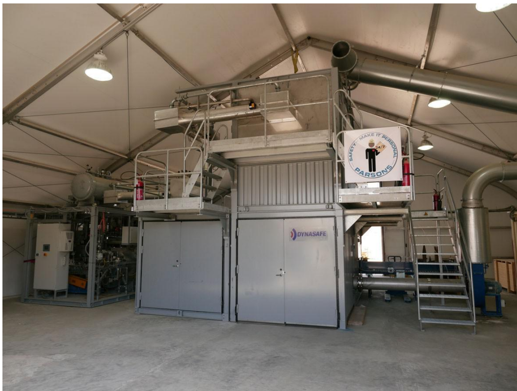
Figura 4. L'impianto di neutralizzazione idrolitica dell'iprite di Ruwagha (foto OPCW).
