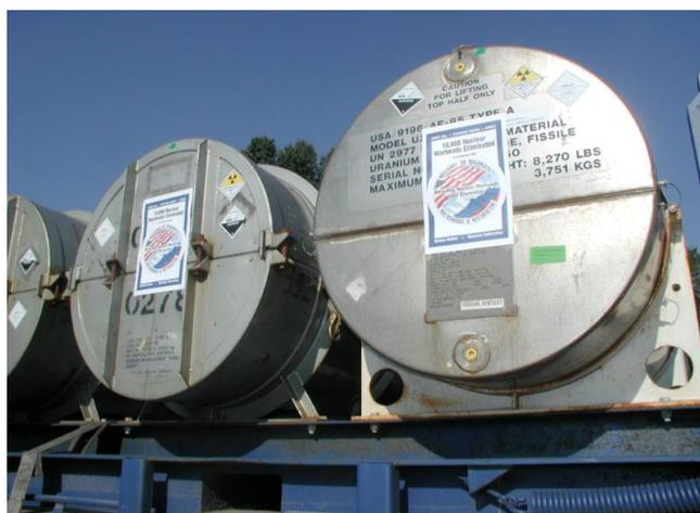
**Figura 1.** Cilindri B 30 contenenti esafluoruro di LEU solido prodotto nell'ambito del programma *HEU to LEU* (foto USEC)
